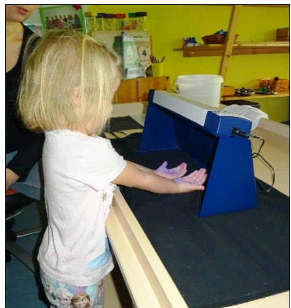
Das Dermalux-Gerät macht mittels UV-Strahlen und einer aufgetragenen Lotion Unsauberkeiten sichtbar.
